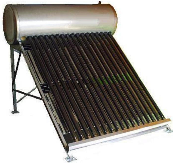
En este tipo de calentadores la tecnología de captación de la energía solar es diferente. Para ello se emplean los llamados tubos de vacío, dentro de los cuales se encuentra la superficie absorbadora. Están provistos de una cámara al vacío en las paredes del tubo para minimizar las pérdidas de calor a la atmósfera.
